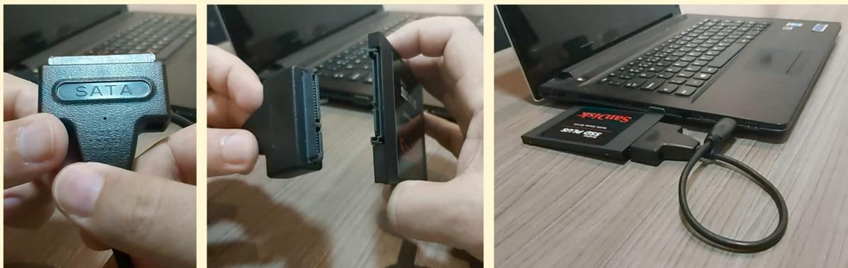
Fig. 3: Cabo conversor USB 3.0 SATA 22 Pin SSD e entrada USB 3.0 (à direita em azul).
